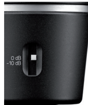
Abbildung 1: Wahlschalter für Vorabschwächung
